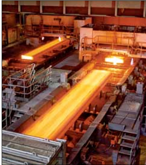
2 Herstellung von Stahlbrammen im Stranggussverfahren
