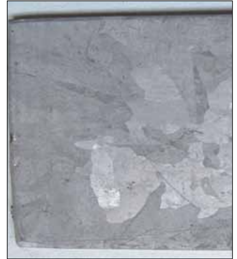
4 Wie neu: Feuerverzinktes Testblech nach 15 Jahren
